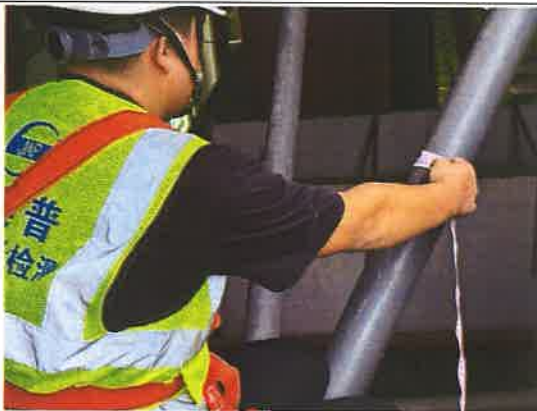
建筑现状完好、构件截面尺寸检测
